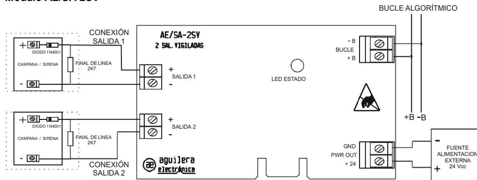
Este módulo requiere tensión de alimentación auxiliar de 24 Vcc para la actuación de las salidas.
